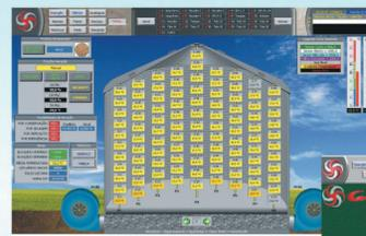
Sistema de termometria com sensores digitais para controle automático da qualidade do produto.
